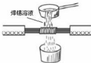
图19 铜导线的锡焊连接
