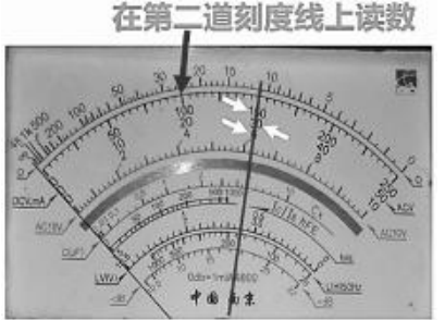
图8 测量直流电压表盘读数方法
