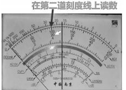
图9 测量直流电流表盘读数方法 (未完待续)
