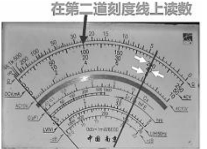
图6 测交流电压表盘读数方法
