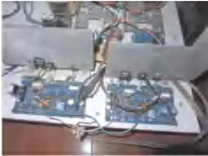
安装调试成功的功放板,散热板尺寸 160mm×90mm。
