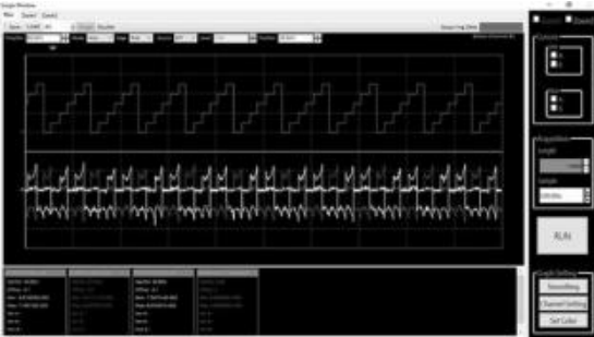
图 5 120 度通电控制的电流波形
