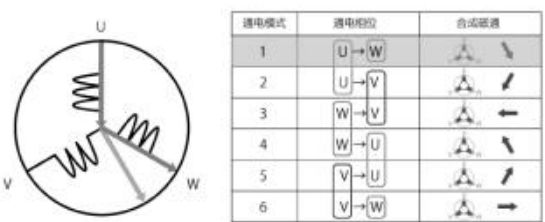
图 6-C: BLDC 电机的转动原理
