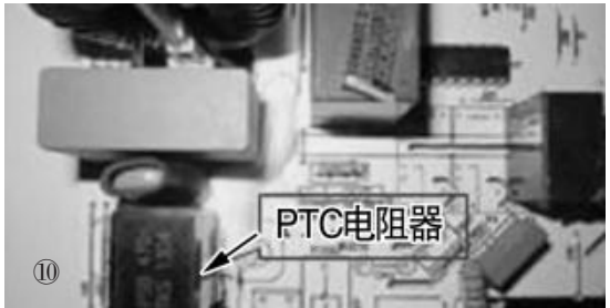
PTC 器件作用为限电流和过电流保护（如图 10
