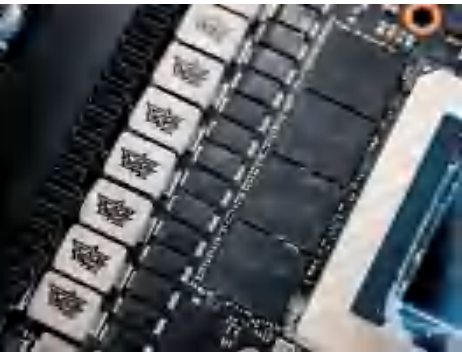
卡皇 ROG STRIX-RTX3090-O24G-GAMING 上的显存颗粒
