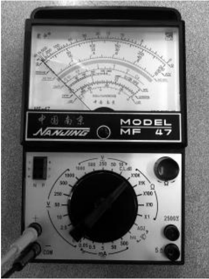
图 1 MF47 型万用表外观正面图
