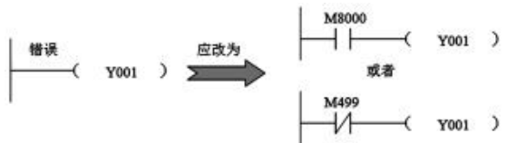
图 1 线圈类符号不可以直接接在左母线上
