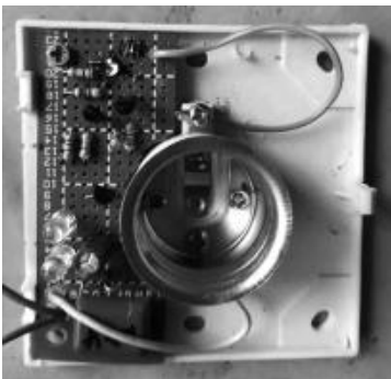
图 2 PCB 版可安装在灯座中
