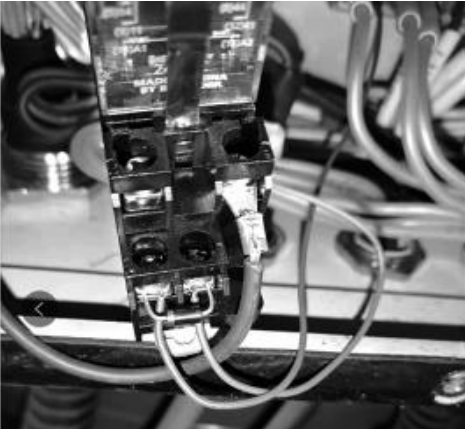
图 4 并接的二极管图
